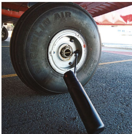
Utilisation de la capsule d'azote capacité 17 litres sur un train principal
