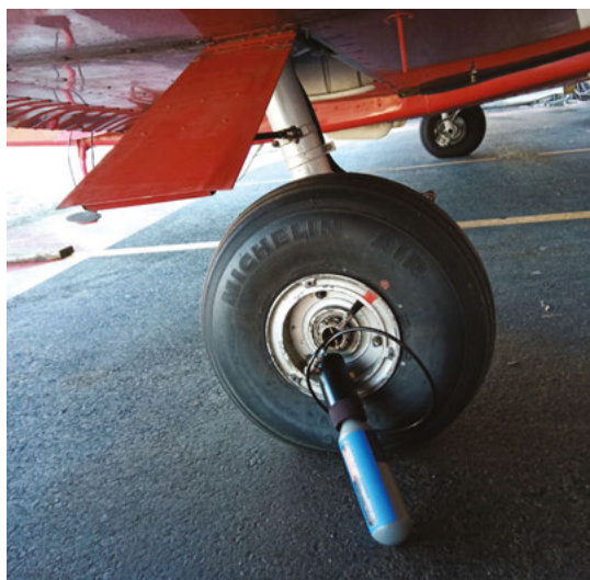
Utilisation de la capsule d'azote haute capacité 34 litres sur un train rentrant
